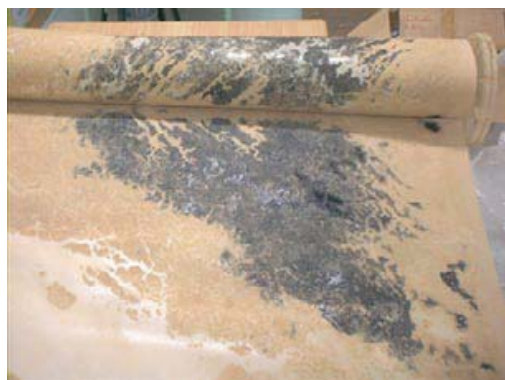
Figura 55. Depósitos de materia orgánica y biopelícula en la superficie de la membrana
